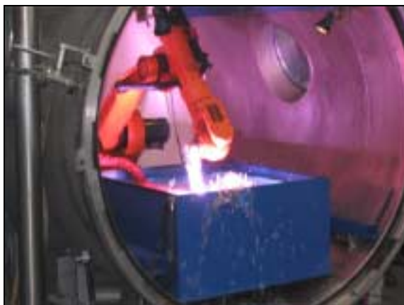
Plasmaschneiden unter Wasser
